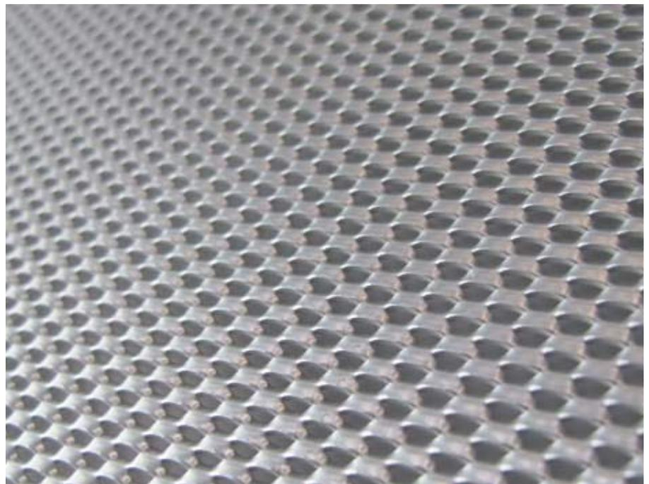
Das flache Bodenprofil vermeidet Stolperfallen und sorgt zusammen mit dem eloxierten Streckmetall-Gitter für ein hochwertiges Aussehen. Durch den Einsatz von Klemmwinkeln können die Lichtschachtabdeckungen bei Bedarf sogar vor Ort noch angepasst werden. Lichtschachtgitter sind ebenso für die Abdichtung von vertikalen Lüftungsschächten geeignet.
